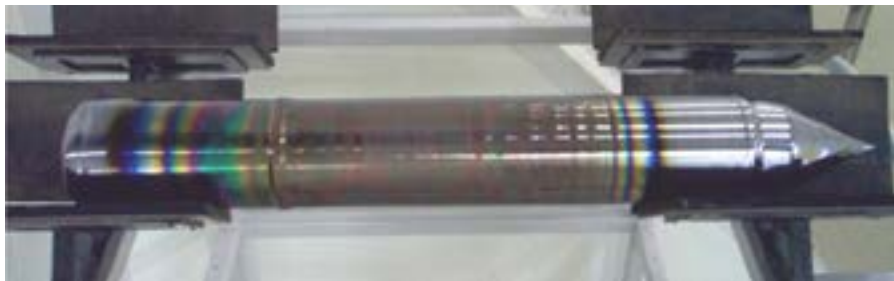
Kryształ krzemu otrzymany metodą Czochralskiego
